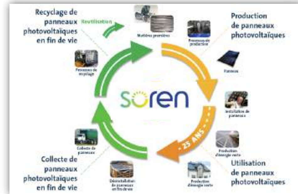
Figure 77 : Analyse du cycle de vie des panneaux polycristallins (source : PVCycle)
