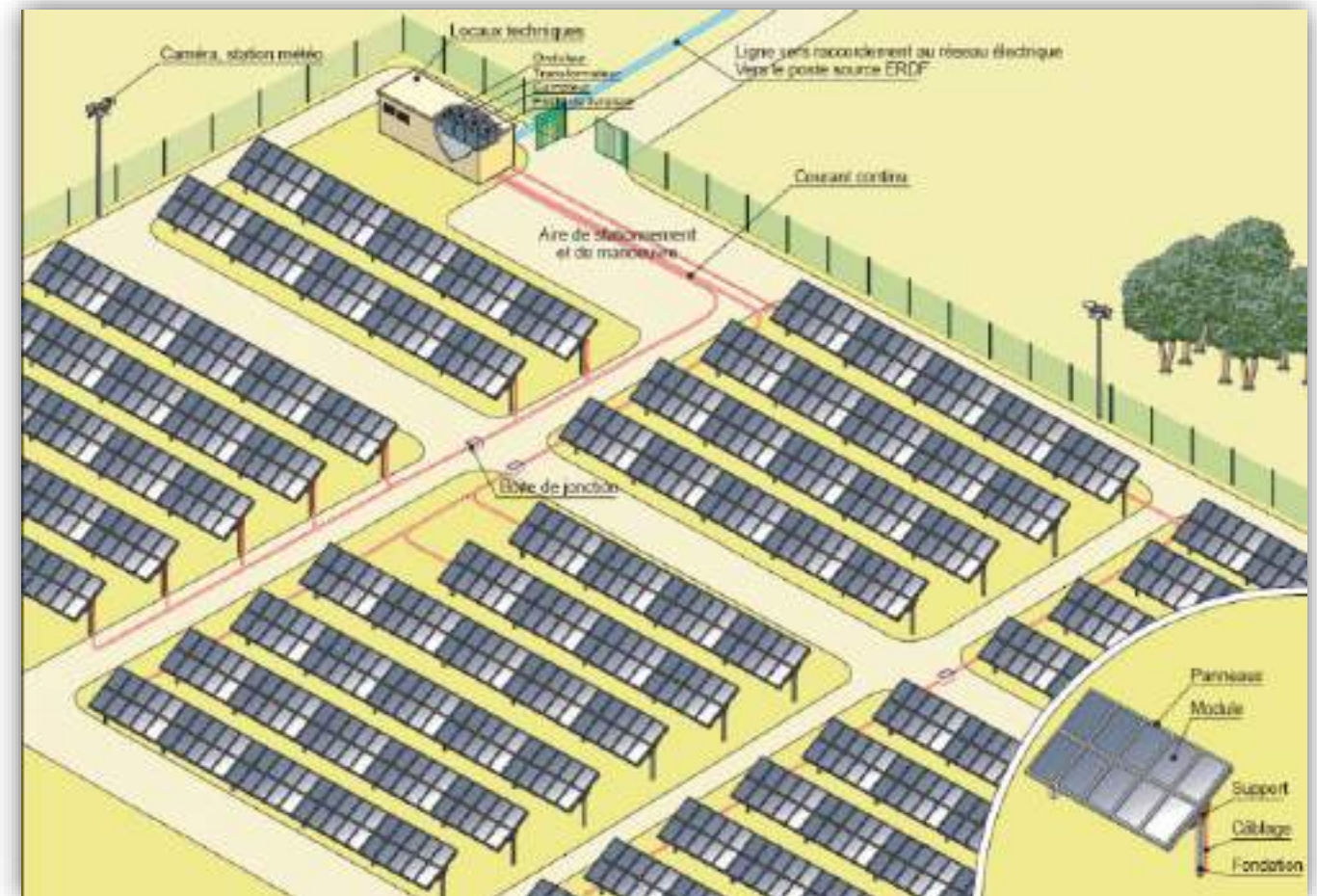
Figure 59 : Principe d'implantation d'une centrale solaire
