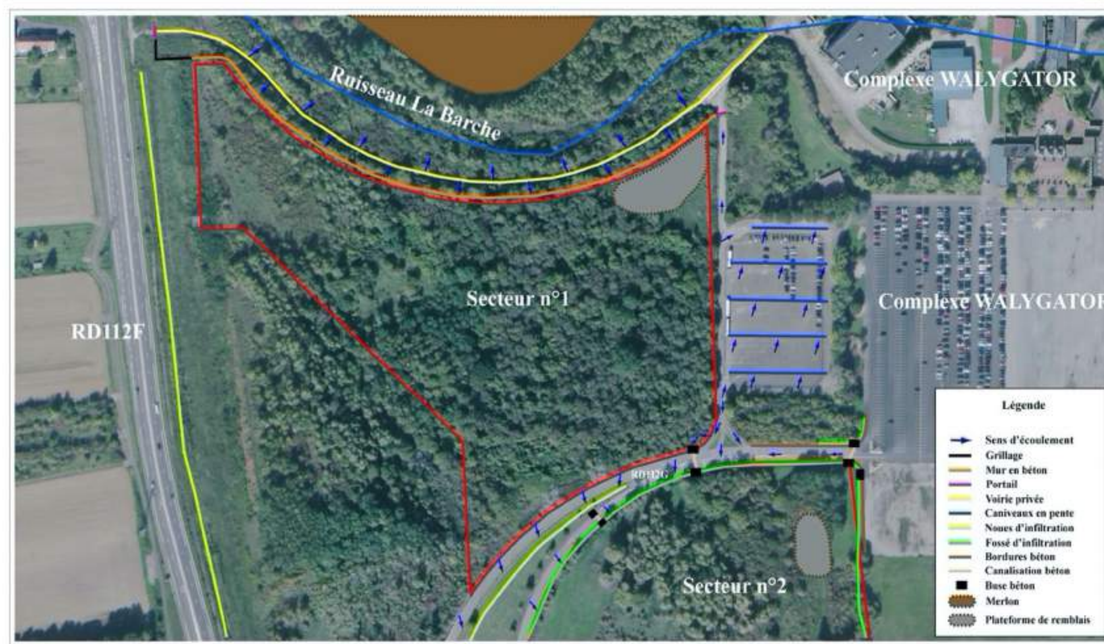
Figure 13 : Schéma des écoulements au droit du secteur n°1
